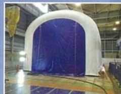
塗装作業時の粉塵対策として特注サイズを採用。エアロシェルター®を作業する場所まで移動させることにより、重量があるタービンを固定したまま、塗装作業が可能に。
